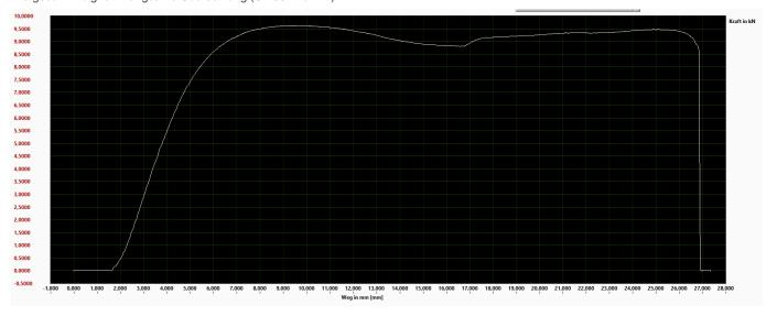
Ergebnis: Öffnung eines Hakens am Spannschloss bei 7,5kN. Max. Nutzlast 150kg bei 5-fachen Sicherheitsfaktor.
