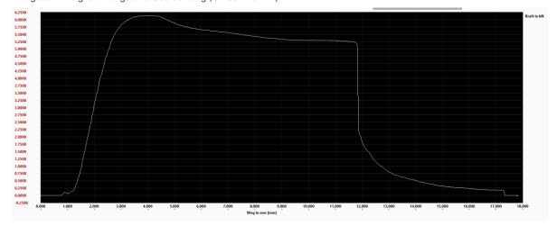
Ergebnis: Haken aufgebogen bei 5,5kN, Bruchlast: 6,0kN.
