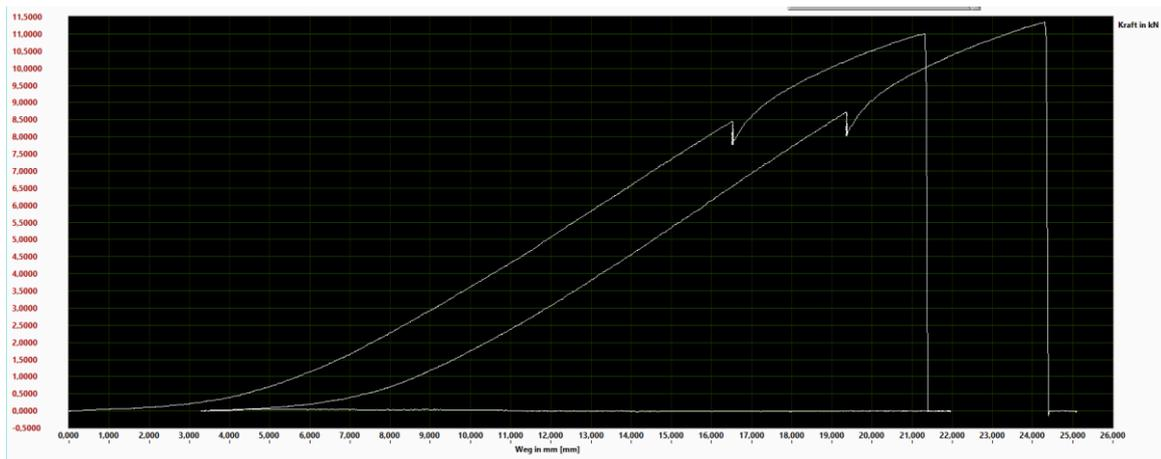
**Ergebnis: Haltezeit von 5min. bei 80% Bruchlast = 7,27kN erreicht, Bruchkraft anschließend min. 10,8kN > 9,09kN (MBK). Bei Einhaltung dieser Verarbeitung ist eine Nutzlast von 140kg bei fünffachem Sicherheitsfaktor möglich.**
