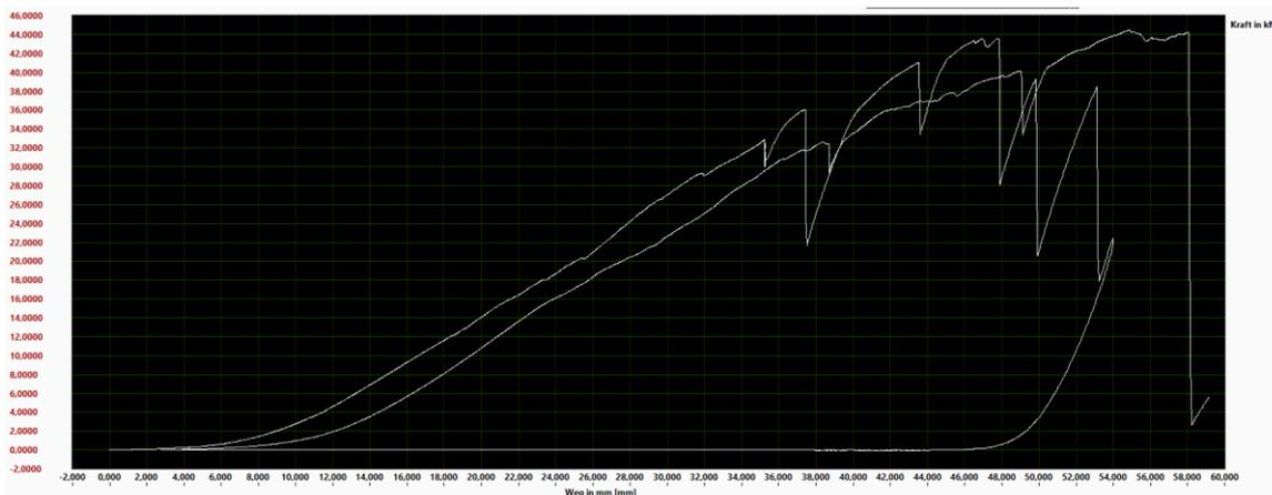
**Ergebnis: Haltezeit von 5min. bei 80% Bruchlast = 29,10kN erreicht, Durchrutschkraft anschließend min. 36,0kN < 36,37kN (MBK). Bei Einhaltung dieser Verarbeitung ist eine Nutzlast von 550kg bei fünffachem Sicherheitsfaktor möglich.**
